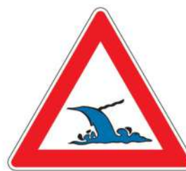
PERICOLO ONDE DI PIENA IMPROVISA 51620 lato 600 mm
