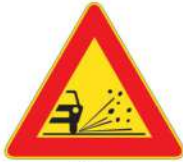
1/390 Materiale instabile sulla strada
