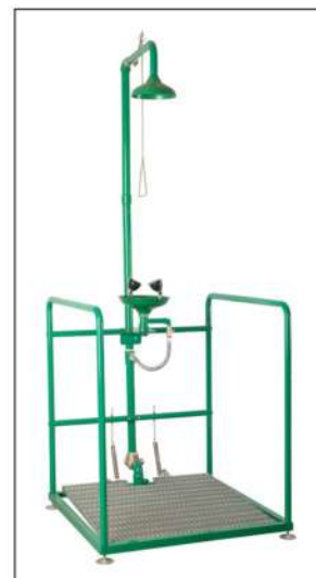
ISC730 Doccia lavaocchi con pedana, soffione, vaschetta in polipropilene e valvola antigelo autodrenante con azione indipendente della doccia tramite tirante.
